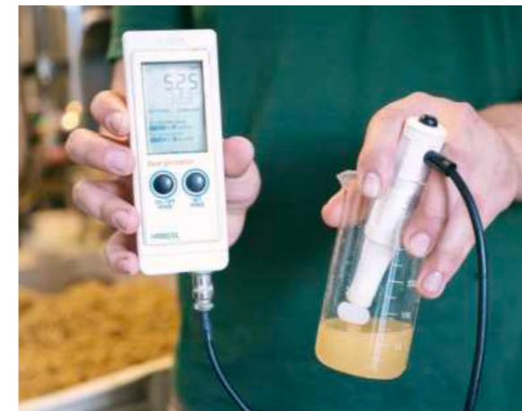
Figura 50. Phmetro per la misurazione dell'acidità nell'acqua. Fonte: Fermento Birra
