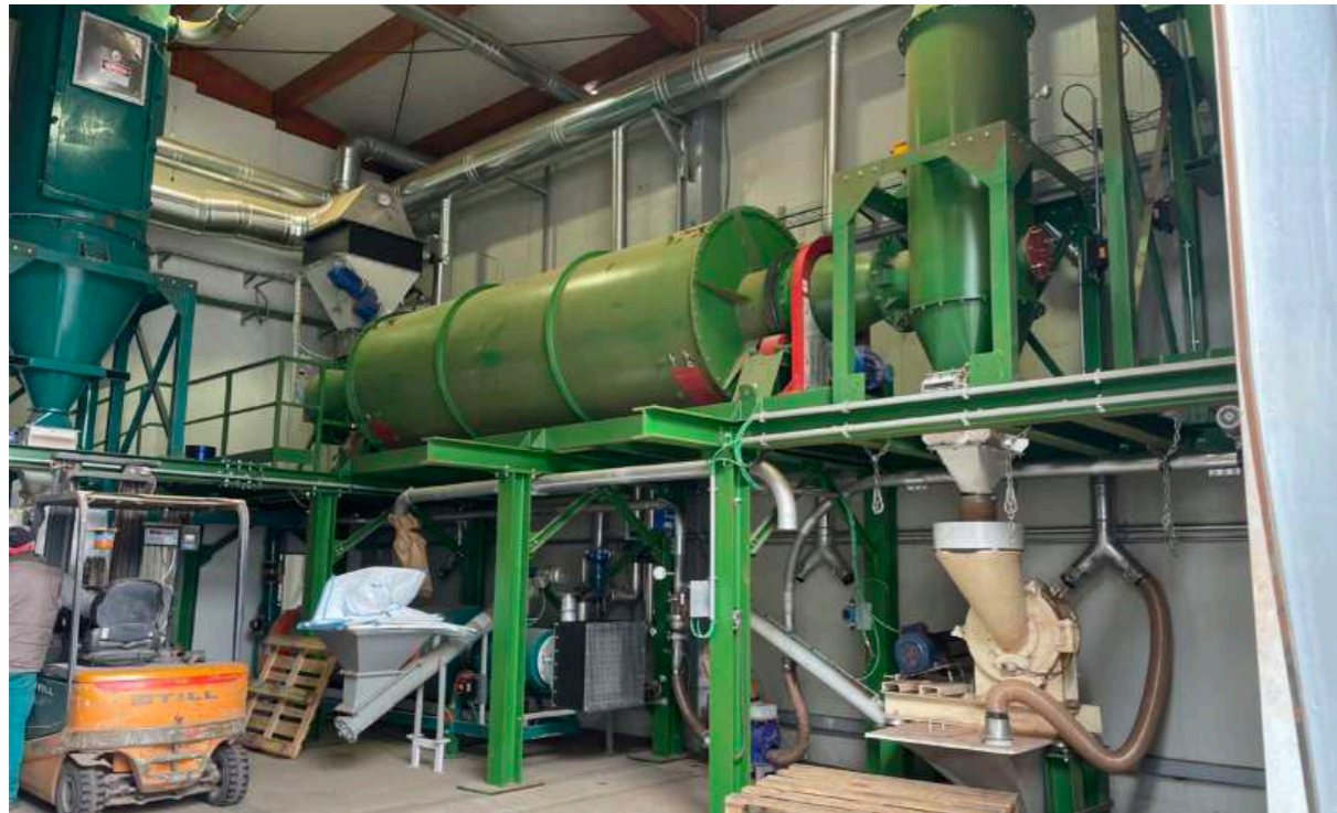
Figura 71. Essiccatore a tamburo di Agrindustria. Fonte: foto dell'autore
