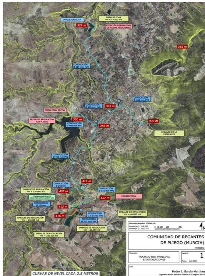
Figure 06. Main network layout and facilities (Comunidad de regantes de Pliego, 2022)
