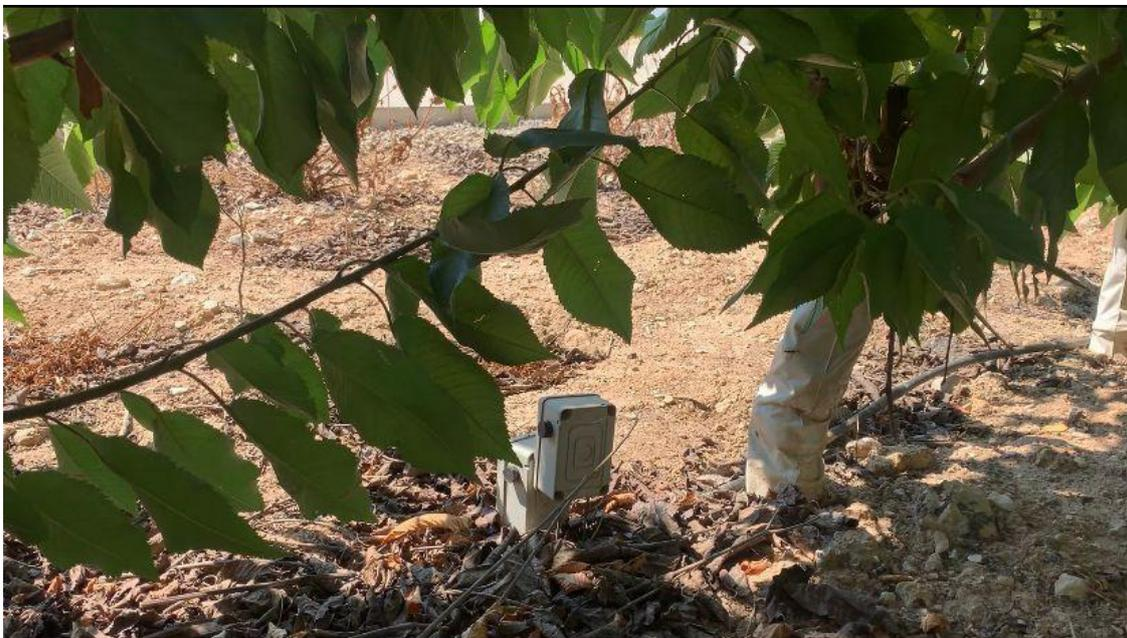
*Figura 14 Humidity sensors in crops of Comunidad de Regantes de Pliego after 2 years*
